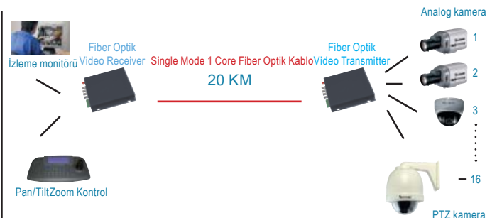
CCTV çözümleri 16 kameralı fiber optik sistem konfigürasyonu
