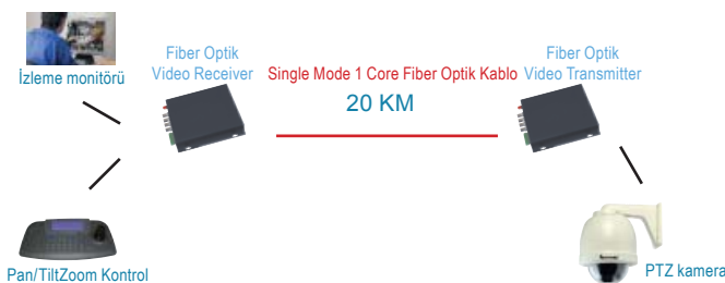
CCTV çözümleri 1 kameralı fiber optik sistem konfigürasyonu
